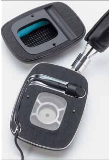
Die Polster haften magnetisch auf dem Gehäuse. Darunter wird der Kabelstecker zugänglich
